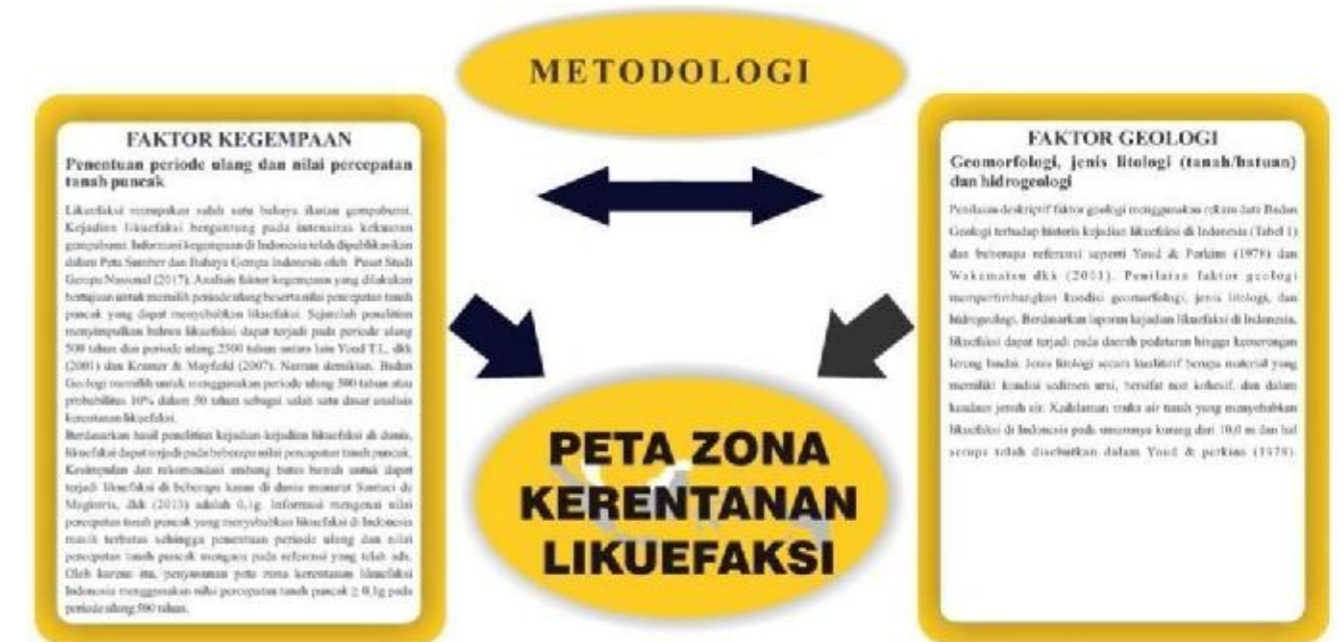
Gambar 3.12. Diagram Alir Proses Penyusunan Indeks Bahaya Likuefaksi Sumber: Atlas Zona Kerentanan Likuefaksi Indonesia, 2019
